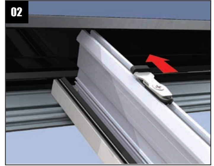
02 Assurer que le clip est dans la position avec la gâchette vers la faîtière.
