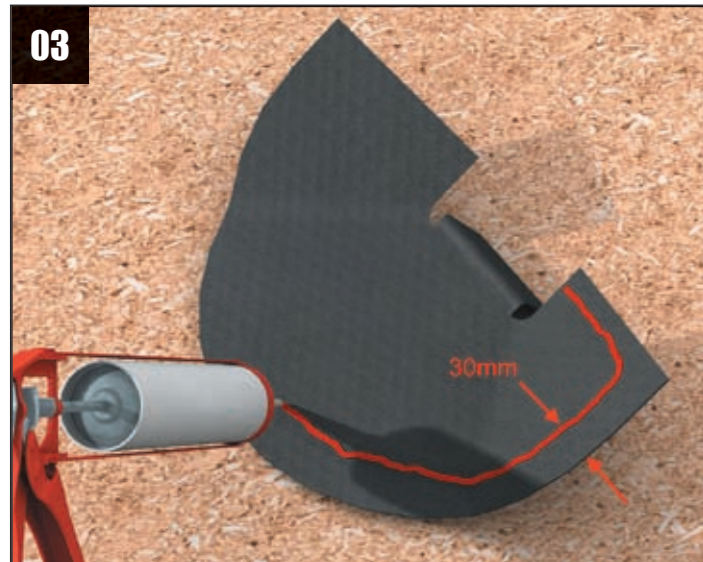
03 Appliquer le 'Gutterbond' sur le dessous de la feuille d'étanchéité.
